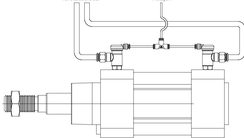
Circuito Pneumatico - Pneumatic Circuit - Pneumatische Schaltung - Circuit pneumatique - Circuito Neumático - Circuito Pneumático
