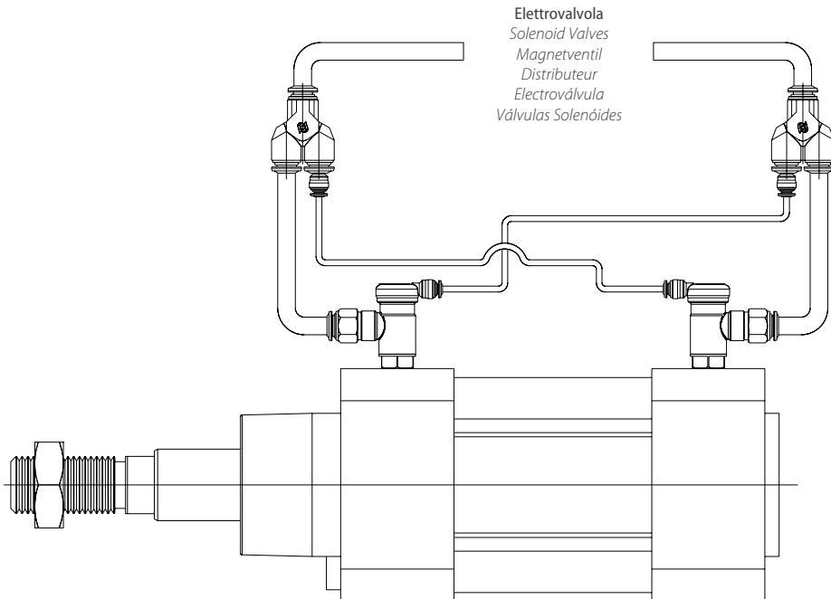
Circuito Pneumatico - Pneumatic Circuit - Pneumatische Schaltung - Circuit pneumatique - Circuito Neumático - Circuito Pneumático
