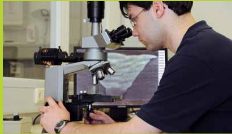
Ensayo de cordón de soldadura bajo el microscopio
