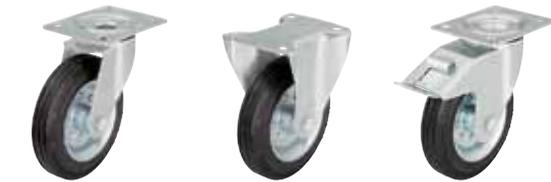
**Soporte:** Serie LE/B - Estampado de chapa de acero, soporte giratorio con doble carril de bolas en cabeza giratoria, con cabeza giratoria sellada. El carril de bolas está remachado dinámicamente según un procedimiento especial de Blickle. Este proceso resulta en un juego mínimo de la cabeza giratoria, una marcha suave y una alta durabilidad debido al endurecimiento en frío del carril de bolas.
