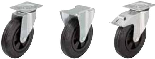
**Soporte:** Serie L/B/BH - Estampado de chapa de acero, soporte giratorio con doble carril de bolas en cabeza giratoria, con robusto vástago central (para ruedas Ø 160-250 mm), con cabeza giratoria sellada. El carril de bolas está remachado dinámicamente según un procedimiento especial de Blickle. Este proceso resulta en un juego mínimo de la cabeza giratoria, una marcha suave y una alta durabilidad debido al endurecimiento en frío del carril de bolas.
