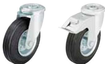
**Soporte:** Serie LER - Estampado de chapa de acero, con doble carril de bolas en cabeza giratoria, robusto vástago central, protección de bolas mediante forma especial de la placa base y arandela esférica. El carril de bolas está remachado dinámicamente según un procedimiento especial de Blickle. Este proceso resulta en un juego mínimo de la cabeza giratoria, una marcha suave y una alta durabilidad debido al endurecimiento en frío del carril de bolas.
