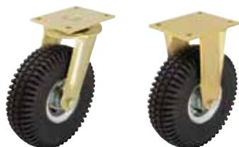
**Soporte:** Serie LS/BS - Construcción de acero soldado extremadamente robusta, soporte giratorio con cojinete axial ranurado de bolas según DIN 711 y cojinete de rodillos cónicos según DIN 720 en la cabeza giratoria, protegido contra polvo y agua salpicada, con engrasador, con vástago central muy robusto, soldado, atornillado y asegurado. Eje de rueda atornillado. Zincado, pasivado color amarillo, libre de Cr6. Resumen de soportes: Página 68 Croquis de las platinas atornillables: Página 78
