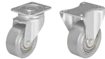
**Soporte:** Serie LH/BH - Estampado de chapa de acero gruesa, soporte giratorio con placa y brazos reforzados, con muy robusto vástago central atornillado y asegurado, con doble carril de bolas en cabeza giratoria, adicionalmente reforzada con **cuatro cojinetes endurecidos de forma especial**, por lo tanto especialmente insensible a golpes y choques.
