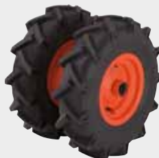
Rueda doble neumática con perfil todo terreno.
