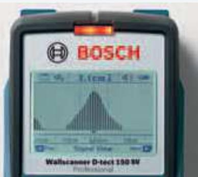
Signal View reproduce directamente los complejos datos de radar. Así, el experto puede reconocer in situ con mayor exactitud particularidades específicas y tenerlas en cuenta en su análisis.
