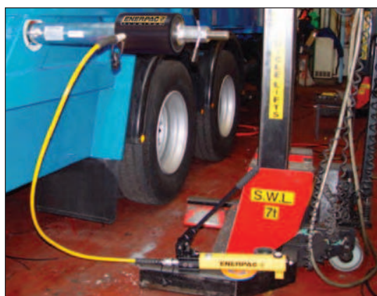
◀ Un RACH-306, impulsado por una bomba manual P-392, se utiliza para extraer pasadores de carro corroidos de vehículos de recolección de basura.
