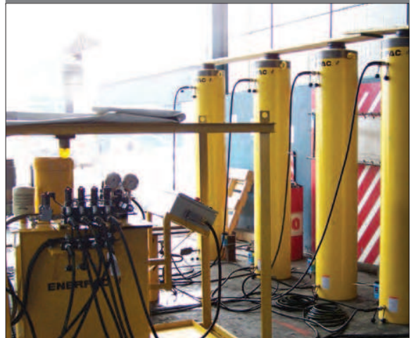
▲ Cilindros personalizados de 500 toneladas con 72 pulgadas de carrera para la elevación de palas de cuerda eléctrica.
