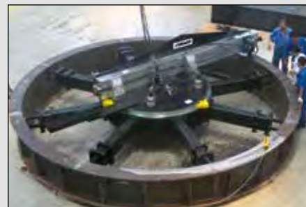
▲ Fresadoras orbitales utilizadas en la construcción naval y generación de energía.
