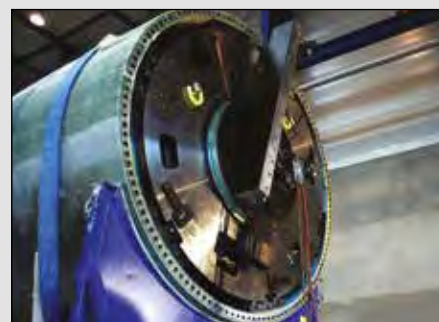
▲ Fresadoras orbitales para la fabricación de turbinas eólicas.
