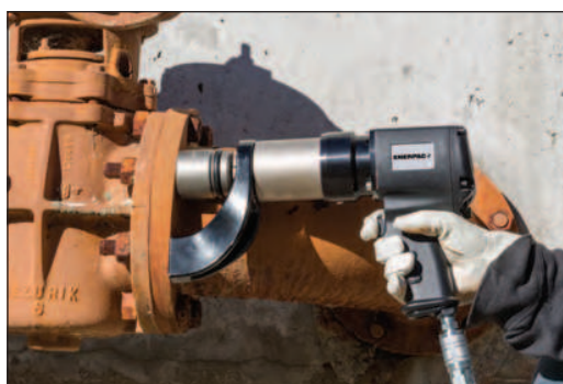
◀ La llave PTW1000 agiliza este trabajo de mantenimiento de bridas.
