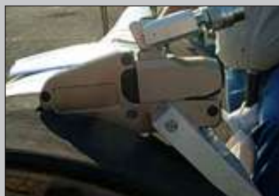
◀ Llaves de torque hidráulicas personalizadas con paletas de reacción para usar con una línea de flujo flexible.
