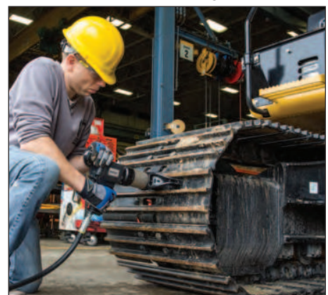
◀ La llave PTW1000 agiliza este trabajo de mantenimiento de bridas.
