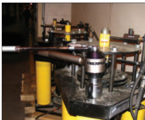
◀ Multiplicador de par con barra de reacción E393 de Enerpac utilizado para apretar manualmente pernos con hasta 3200 lbs-pie (4340 Nm).
