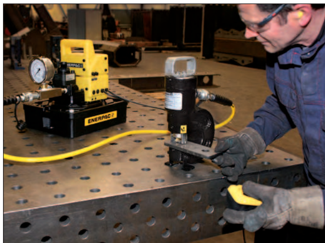
▼ Botador hidráulico ligero de la serie SP – mucho más rápido que perforar.
