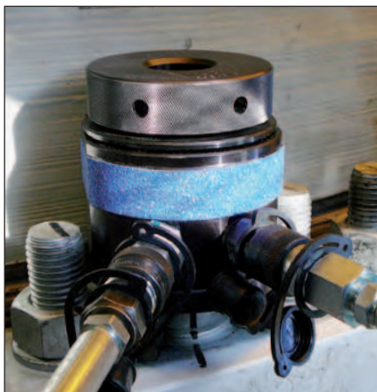
▼ Tensionador de Pernos GT2 en una unión de brida.
