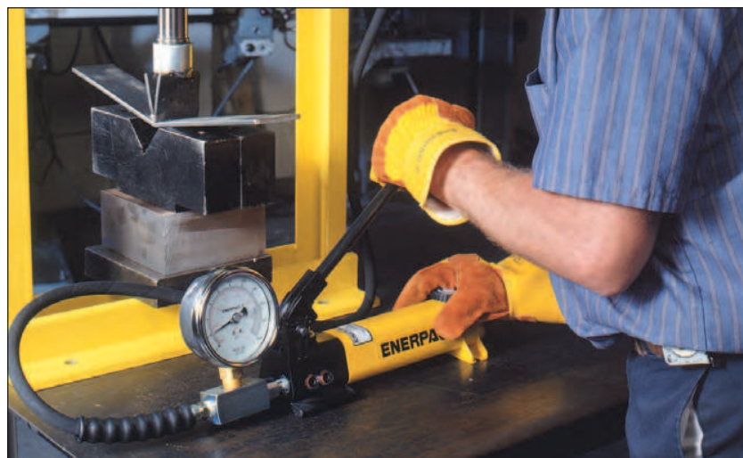
▼ Se usa un manómetro GP-10S en esta prensa para medir la presión hidráulica requerida para doblar una barra plana de acero.
