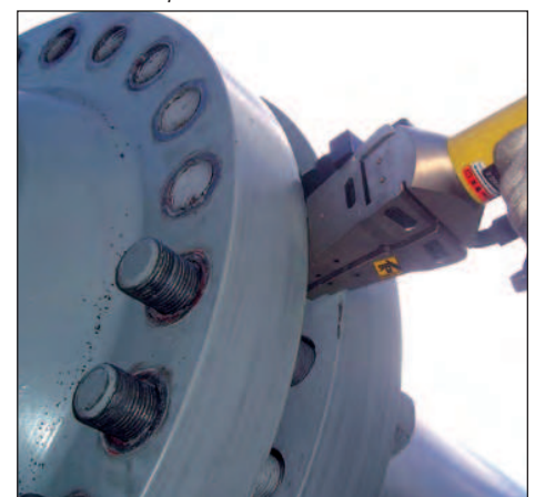
▼ Dos separadores FSH-14 se utilizan simultáneamente con bomba manual, mangueras y manifolds de flujo dividido AM-21 Enerpac.
