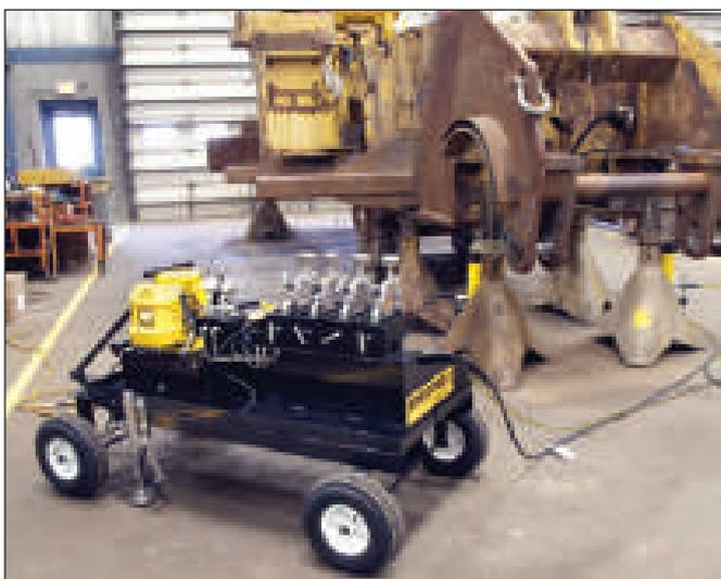
◀ El sistema de levantamiento nivelado ofrece una solución segura de elevación rápida durante la reconstrucción de un vehículo fuera de la autopista.
