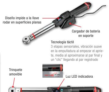
Capacidades 1.5NM-340NM Unidades de medición NM/LB Precisión +/- 2% Función ángulo integrada
