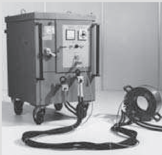
▼ Los aros de calentamiento sirven para desmontar los aros interiores de rodamientos de rodillos cilíndricos
