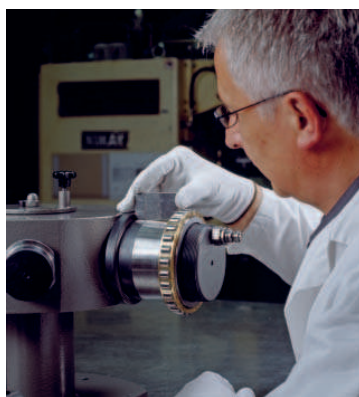
12: Determinación de la distancia hasta el borde del eje
