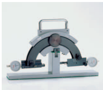
19: Instrumento de medición FAG MGK 133
