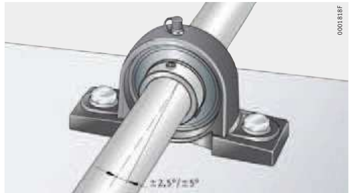
Figura 3 Compensación de errores de alineación estáticos del eje
