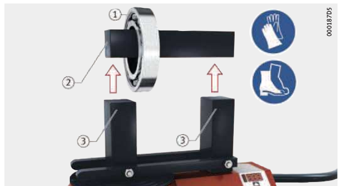
Figura 15 Retirar el rodamiento en posición horizontal
