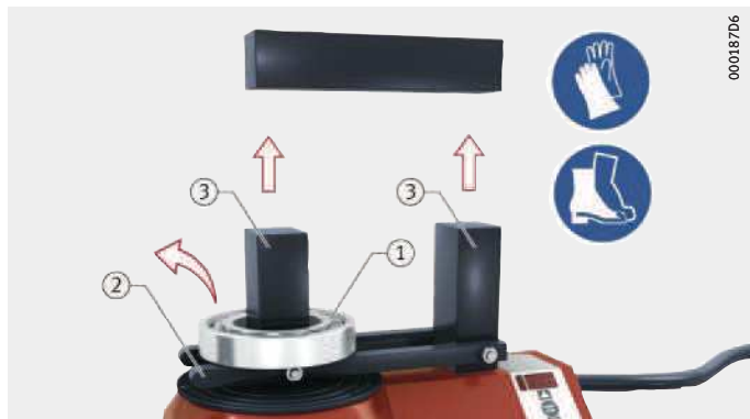
Figura 16 Retirar el rodamiento en posición horizontal
