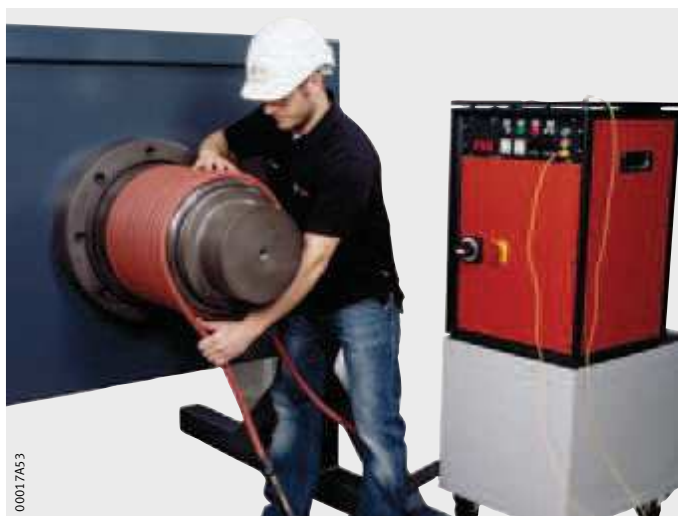
Figura 1 Es posible envolver la pieza con el inductor flexible
