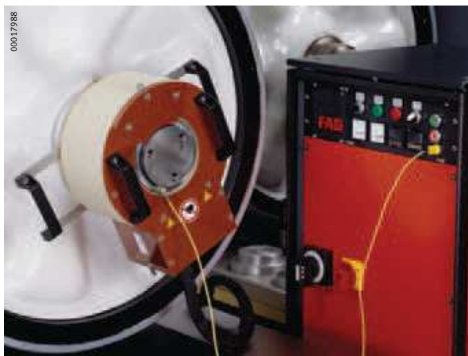
Figura 2 Inductor rígido en el desmontaje de rodamientos de rueda de vehículos sobre raíles
