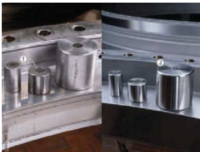
Figura 7 Las pistas de rodadura y los rodillos del rodamiento antes y después del reacondicionamiento
