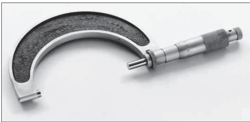
3: Una posición segura y una medición correcta de asientos cilíndricos están garantizados con este dispositivo de arco. El disco-calibre marca el diámetro en el cual el aparato debe regularse.
