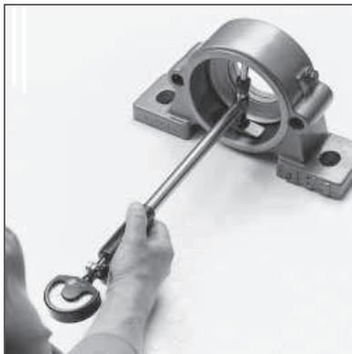
7: Medición con un instrumento de agujeros (esquema). Se determina la medida mínima.
