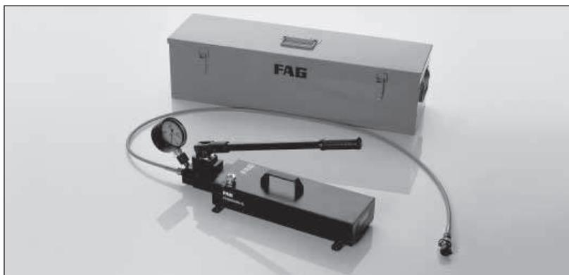
54: Bomba manual FAG PUMPE2500.8L.V, consiste en una bomba de pistón de doble etapa (2500 bar) con depósito de 8 l, válvula doble vía, manómetro, 2 tubos alta presión, 2 conectores rápidos G 1/4, 2 adaptadores y 6 reductores, caja metálica.
