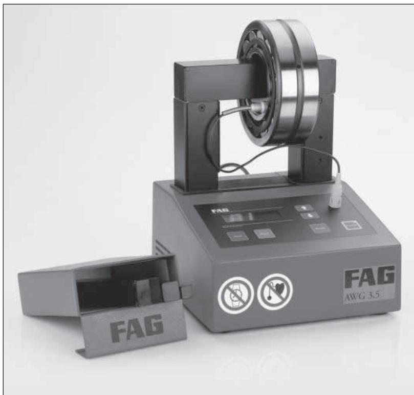
43, 44: Calentamiento rápido limpio y seguro a temperatura de montaje mediante el aparato inductivo de calentamiento.
