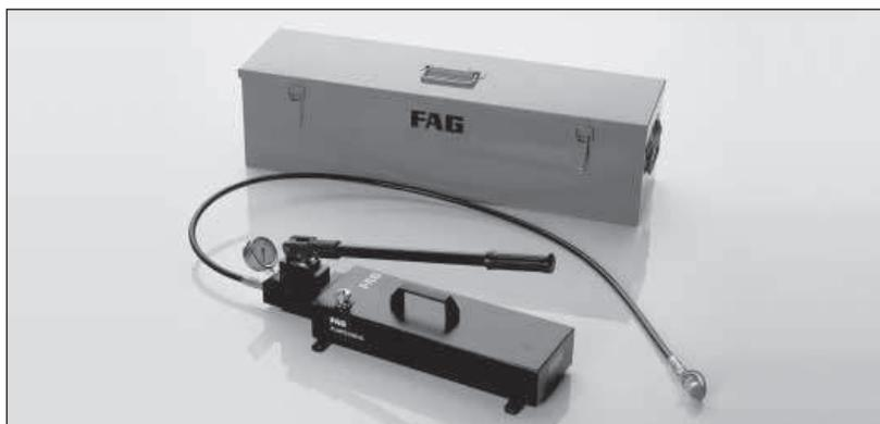
52: Bomba manual FAG PUMPE1000.4L, consiste en una bomba de pistón de doble etapa (1000 bar) con depósito de 4 l, manómetro, tubo alta presión, conector rápido (rosca G 1/4), caja metálica.
