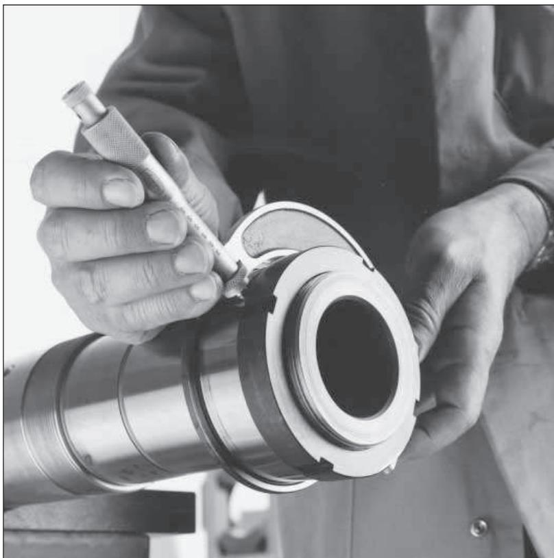
Para calar un rodamiento sobre el asiento cónico o para montar con prensa un manguito de desmontaje se usan dispositivos mecánicos o hidráulicos. El sistema de montaje a elegir depende de las condiciones de montaje.
