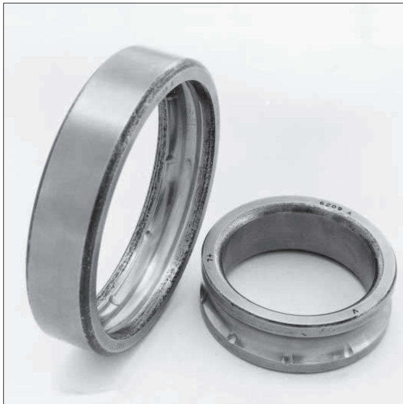
108: Marcas de los cuerpos rodantes en los caminos de rodadura de un rodamiento rígido de bolas debidas a un montaje defectuoso.
