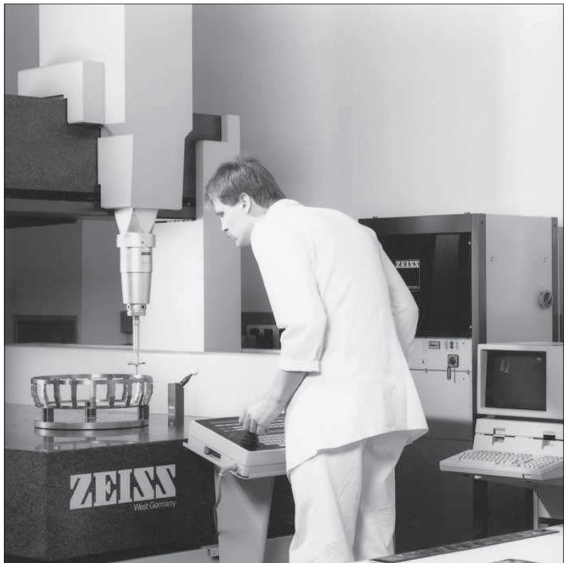
105: Máquina de medición de coordenadas
