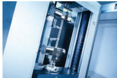
Bruchkraftermittlung und Dehnungsaufnahmen bis 1000kN
