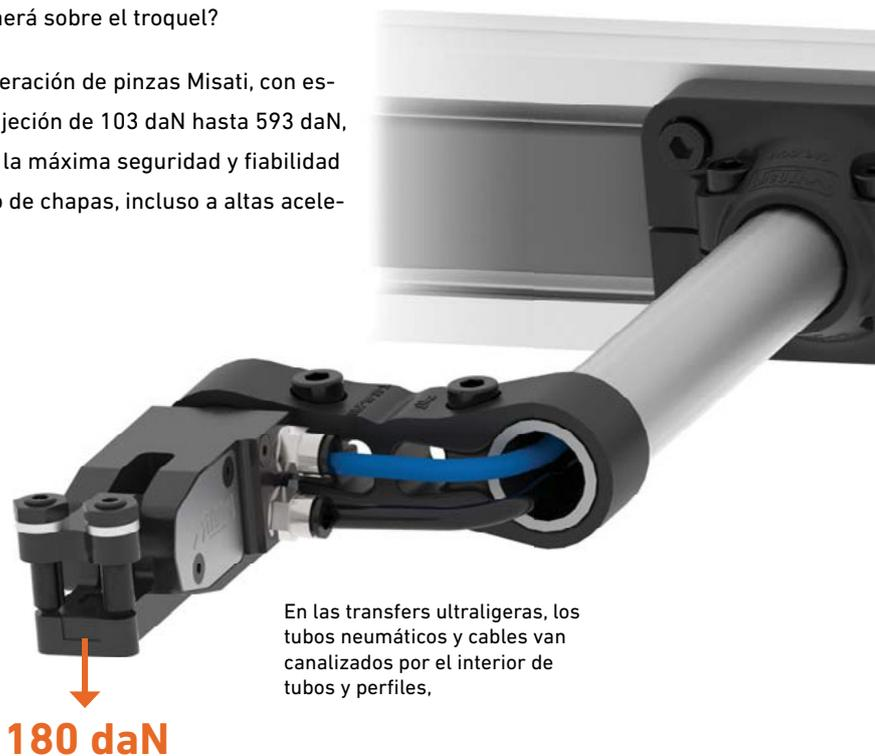
En las transfers ultraligeras, los tubos neumáticos y cables van canalizados por el interior de tubos y perfiles,
