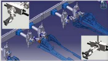
La unidad de giro rotará la chapa por su centro de giro. Para asegurar la perfecta sujeción chapa, las pinzas se sitúan en el radio necesario del eje de giro.
