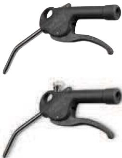
Pistolas para soplado con aire comprimido para limpieza o secado de piezas, arrastre de viruta, etc. Realizadas en termoplástico de alta calidad con boquilla de salida metálica. Versiones con regulador de caudal o boquilla silenciosa. Presión de aire mínima/máxima: 4/10 bar. Conexión de entrada 1/4" BSP (H).
