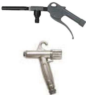
Pistola para lavado con agua y aire comprimido. La pistola combina el agua con el aire comprimido, aumentando la presión de salida del agua de la red. Conexión entrada de agua mediante conector compatible con enchufe para agua. Conexión entrada de aire 1/4" BSP (H).
