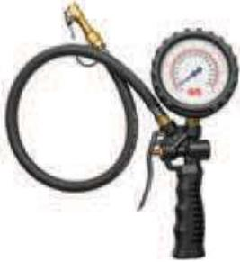
Verificador de presión inflado manual. Permite el control del llenado y el vaciado de la presión de aire en el neumático. Incluye: manómetro indicador de la presión, graduado de 0 a 12 bar, con protector antigolpes, empuñadura ergonómica, flexible de 650 mm y boquilla autosujetable. Conexión de entrada 1/4" BSP (H).
