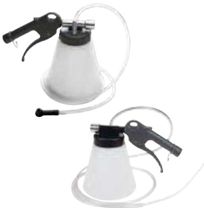
Pistolas con depósito para aspiración de líquidos, de accionamiento neumático, la depresión creada en el depósito de la pistola aspira el líquido hacia el mismo.
