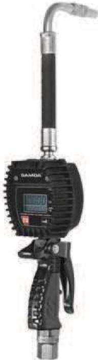
Pistolas contadoras volumétricas con registrador electrónico. Provistas de cámara volumétrica de engranajes ovales, registrador electrónico de lectura digital, tecla de calibración para un fácil ajuste del volumen real dispensado, empuñadura ergonómica antideslizante, con acoplamiento embreadado al cuerpo del registrador que asegura un perfecto alineamiento con el eje de la empuñadura, libre de fuga; gatillo de regulación de caudal y rútdula giratoria en la conexión de entrada.
