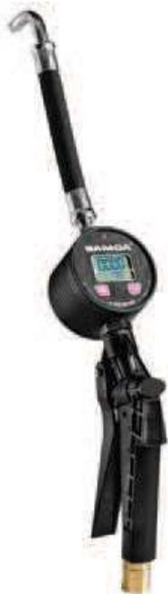
Pistolas contadoras volumétricas con registrador electrónico. Provistas de cámara volumétrica de engranajes ovales, registrador electrónico de lectura digital, tecla de calibración para un fácil ajuste del volumen real dispensado, empuñadura ergonómica realizada en termoplástico de alta resistencia, gatillo de regulación de caudal y rótula giratoria en la conexión de entrada.
