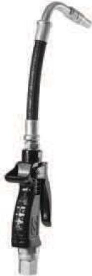
Pistolas para control de aceite medio caudal construidas en aluminio. Provistas de mecanismo de accionamiento progresivo de doble válvula mediante el gatillo de regulación que permite un óptimo control del caudal de entrega mínimo/máximo. Empuñadura ergonómica antideslizante con rótula de entrada. Presión máxima: 105 bar.
