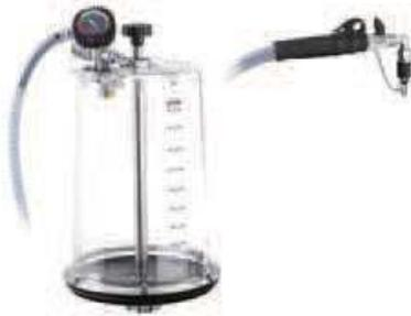
Pre-cámara visualizadora transparente de alta resistencia, de 10 l de capacidad y sistema de vaciado rápido "Twist Lock" que permite, a su vez, la comunicación con el depósito. Dotado de bomba neumática de vacío de alto rendimiento y bajo nivel sonoro con vacuómetro, manguera de aspiración de 2 m con empuñadura de caucho y conector universal tipo **Mercedes Benz** con tapón antigoteo. Conexión a depósitos de aspiradores mediante unión roscada 1 1/2" BSP (H).
