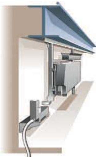
Unidades con depósito de 60 l diseñadas para ser instaladas suspendidas del voladizo de un foso, desplazándose sobre la pared. El depósito articulado sobre chasis de la unidad incorpora un embudo con tapas ajustable en altura y un indicador de nivel. Cuando la unidad está llena, se desplaza el conjunto del carro hasta un extremo del foso procediéndose a la descarga instantánea a una cisterna enterrada o a un depósito intermedio de evacuación.
