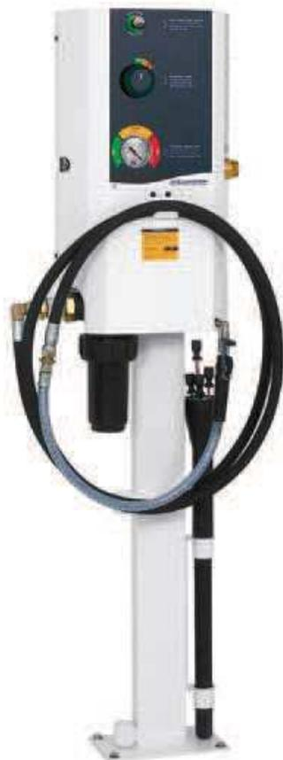
Unidad para recuperación del aceite usado de vehículos mediante aspiración, utilizando una sonda a través de la guía de nivel de aceite del motor. El sistema permite la aspiración del aceite usado y su impulsión, al mismo tiempo, a un depósito de almacenamiento remoto. Instalada en la área de trabajo, es un método limpio de extracción del aceite usado de los vehículos.
