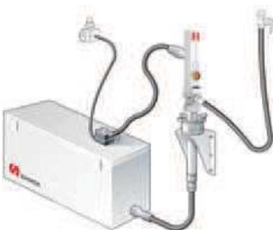
Unidades diseñadas para ser instaladas en el interior de un foso, conectadas a uno o más terminales de un carro articulado para foso. Una bomba neumáticas accionada al alcanzar un determinado nivel mínimo/máximo, permite transvasar automáticamente el aceite usado a cisternas remotas.
