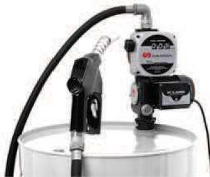
Kits de suministro instalables con bombas de corriente alterna 230 V serie Polaris, contador, accesorios de conexión y servicio según configuración. Versiones con bomba de 50 ó 70 l/min, boquerel standard o automático, contador volumétrico analógico (999 l) y mangueras de servicio.
