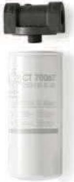
Filtros para gasóleo que permiten la eliminación de impurezas hasta 30 micras y del agua contenida en el combustible, gracias al material hidrófobo del elemento filtrante, evitando el suministro de gasóleo contaminado. Unidades suministradas con cabezal porta filtro con conexión roscada, o sólo filtro para recambio.
