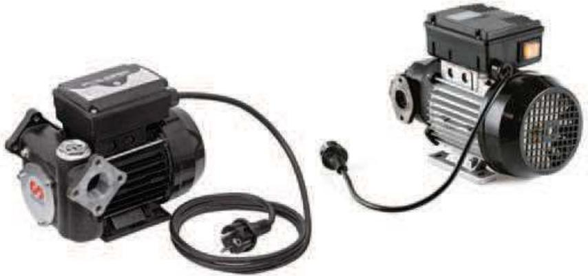
Electrobombas para transvase de gasóleo serie Polaris, dotadas de motor de corriente alterna 230 V. Potencias de motorización, 370, 500, ó 750 W, ofrecen un rango de caudales de entrega (50, 70 ó 95 l/min), según la necesidad exigida.
