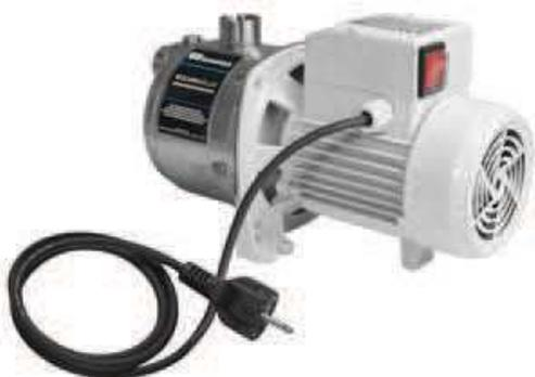
Electrobombas para transvase soluciones de urea o agua, dotadas de motor de corriente alterna 230 V 370 W. Bomba centrífuga auto-aspirante.
