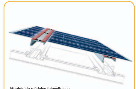
Montaje de módulos fotovoltaicos.
