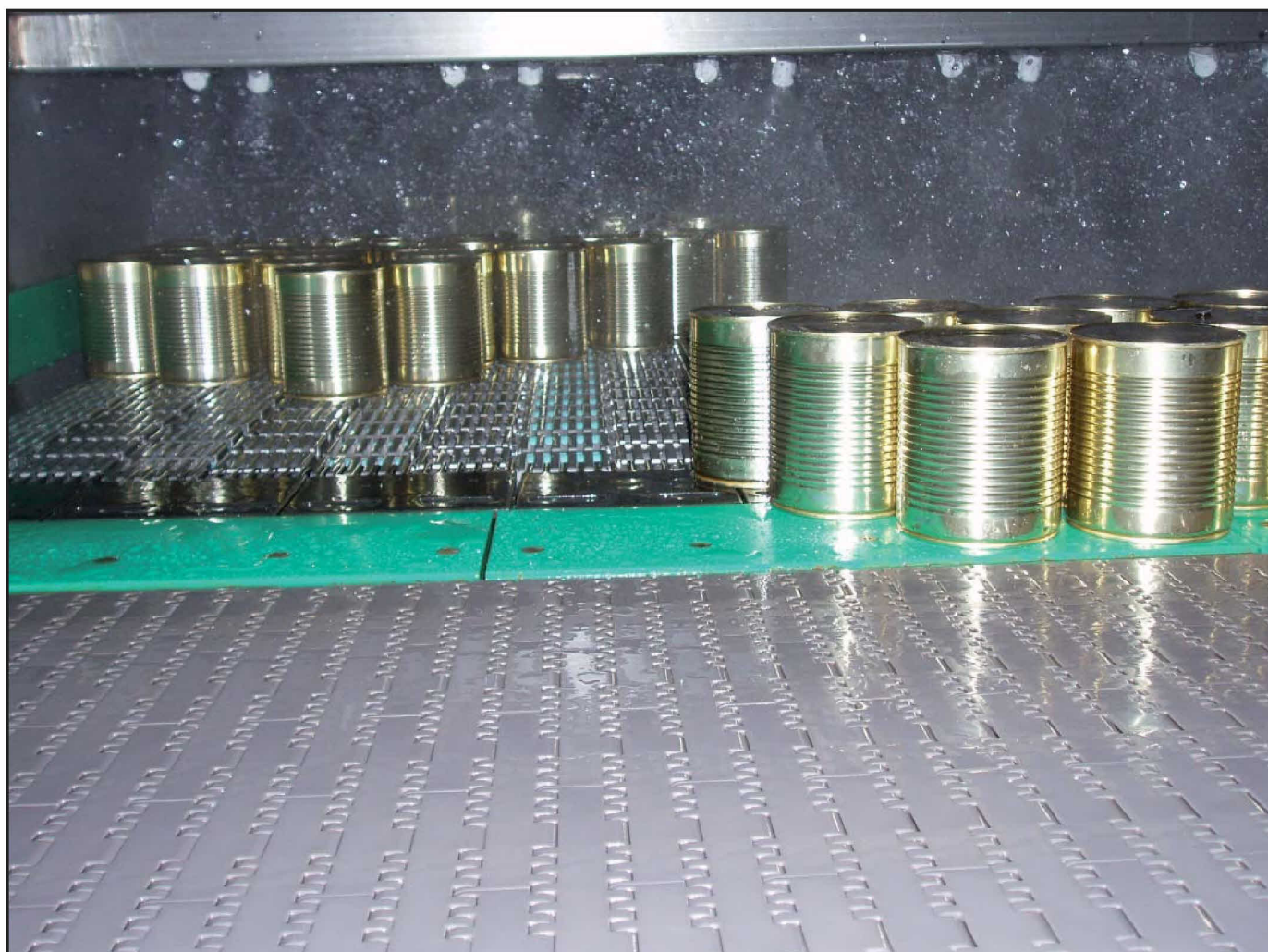
CINTA FORTREX 9227 EN UN TÚNEL DE PASTEURIZACIÓN DE ALIMENTOS
