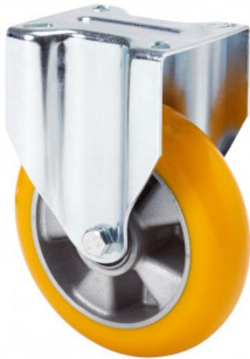
Ruedas con núcleo de aluminio y banda de poliuretano fundido con dureza de 95° shore A, con banda de rodadura en forma balona, especialmente indicada para soportar altas cargas hasta 750 Kg.
