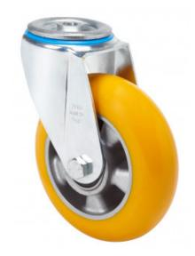
Ruedas con núcleo de aluminio y banda de poliuretano fundido con dureza de 95° Shore A, con banda de rodadura en forma balona, especialmente indicada para soportar altas cargas hasta 400 Kg.
