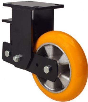
Ruedas con núcleo de aluminio y banda de poliuretano fundido con dureza de 95° Shore A con banda de rodadura en forma balona, especialmente indicada para soportar altas cargas hasta 800 Kg. Con soporte de suspensión elástica mediante incorporación de muelle muy resistente para absorber golpes, choques y desniveles. Recorrido de suspensión hasta 25mm., ideal en suelos irregulares donde su amortiguación actúa.
