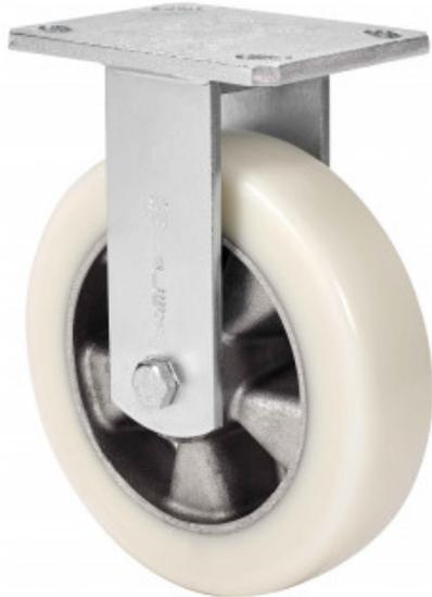
Ruedas con núcleo de aluminio y banda de poliuretano blanco fundido con dureza de 88° shore A, especialmente indicada para soportar altas cargas hasta 650 Kg.
