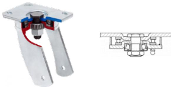
Fabricada con chapa de acero hasta 8m/m de espesor. Doble cabezal giratorio, el superior de bolas grandes de acero y el inferior de precisión que facilita los esfuerzos de giro, radiales y axiales. Modelo construido especialmente para: carretillas grandes con empuje mecánico, manutención de factorías, industrias metalúrgicas. Acabado cincado blanco. Fabricadas según normas europeas EN 12532.
