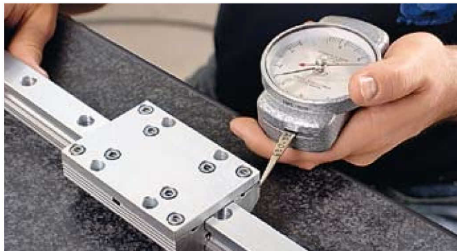
Figura 2: Medir la resistencia al deslizamiento
