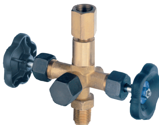
Válvula de cierre con conexión de prueba según DIN 16272 con cierre separado, racor de sujeción hembra/macho G 1/2, con espiga de prueba M20 x 1,5, PN 400
