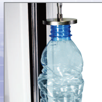
Ensayo de Top-load
