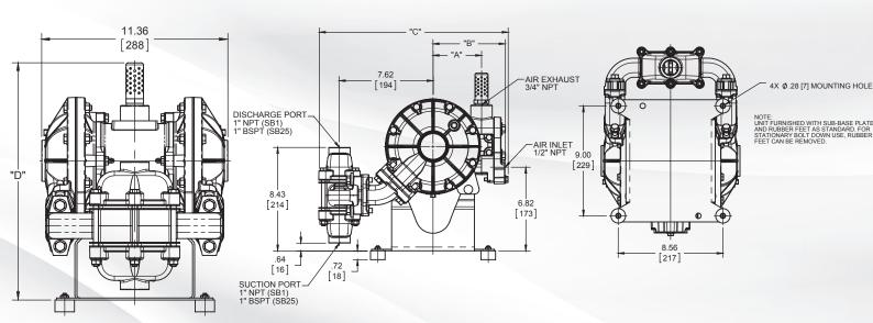
HEAVY DUTY BALL VALVE PUMP BOTTOM PORTED
